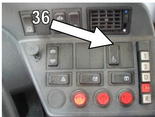
La rampa dispone de sensibilidad, con lo cual, si encuentra un obstáculo en el camino, se repliega sola. Una vez desplegada, se acciona automáticamente el freno de parada y podremos abrir la puerta central.
