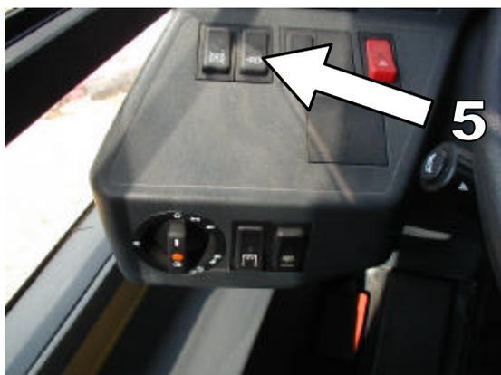
En carreteras con firme resbaladizo se debe desconectar el retardador. Para ello, apretar el interruptor 4 y de este modo solo actuará el freno de servicio mediante los forros de freno
