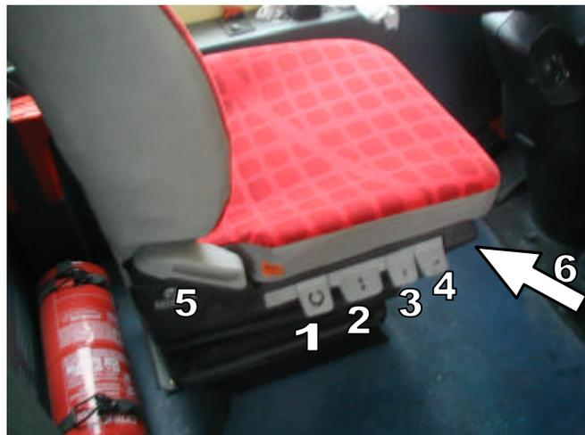
Ajustes: 1. Giro del asiento – 2. Ajuste de altura – 3. Ajuste de amortiguación – 4. Ajuste de inclinación de banqueta – 5. Ajuste de inclinación de respaldo – 6. Palanca de ajuste longitudinal.
