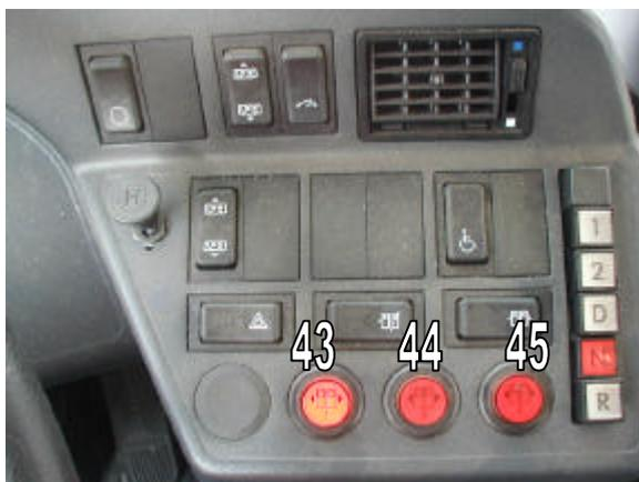
Al abrir cualquier puerta el pulsador permanece iluminado y el freno de parada queda conectado. Se desconectará al cerrarla y pisar levemente el pedal acelerador.
