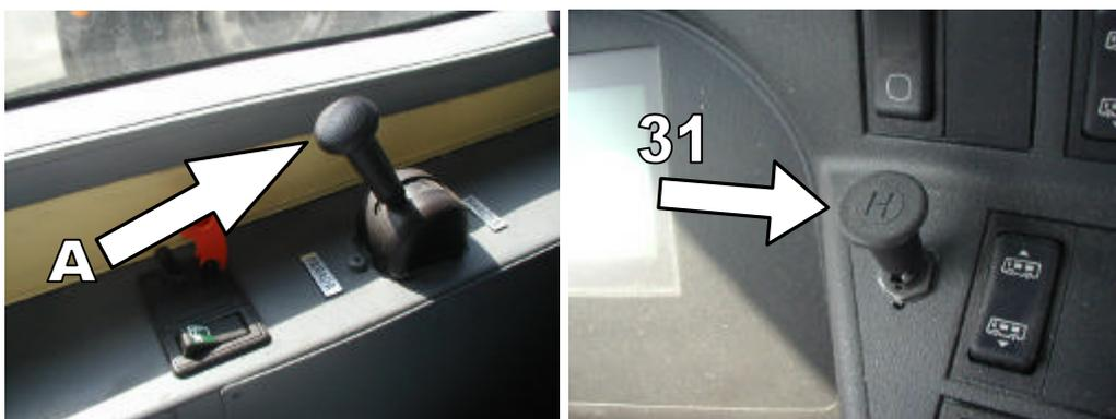
El **freno de parada** (31) sirve para retener el vehículo en un semáforo, por ejemplo, sin necesidad de mantener apretado el pedal de freno.
