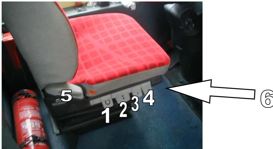
Ajustes: 1. Giro del asiento – 2. Ajuste de altura – 3. Ajuste de amortiguación – 4. Ajuste de inclinación de banqueta – 5. Ajuste de inclinación de respaldo – 6. Palanca de ajuste longitudinal.
