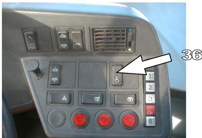
La rampa dispone de sensibilidad, con lo cual, si encuentra un obstáculo en el camino, se repliega sola. Una vez desplegada, se acciona automáticamente el freno de parada y podremos abrir la puerta central.
