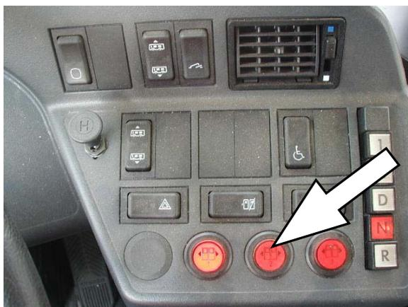
Al abrir cualquier puerta, el freno de parada queda conectado. Se desconecta al cerrarla y pisar levemente el pedal acelerador.
