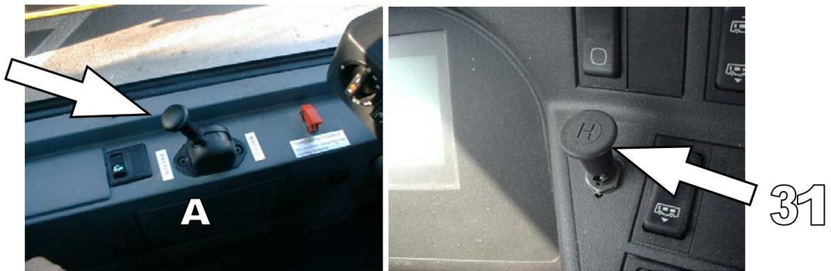
El **freno de parada** sirve para retener el vehículo en un semáforo, por ejemplo, sin necesidad de mantener apretado el pedal de freno.
