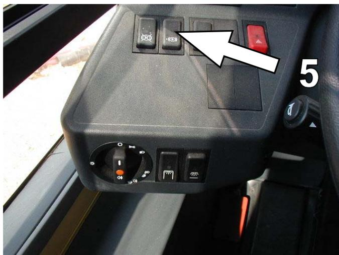
En carreteras resbaladizas se debe desconectar el retardador. Para ello, apretar el interruptor (4, ver dibujo cuadro de instrumentos) de la foto y entonces, si pisamos el pedal de freno, el retardador no actúa.
