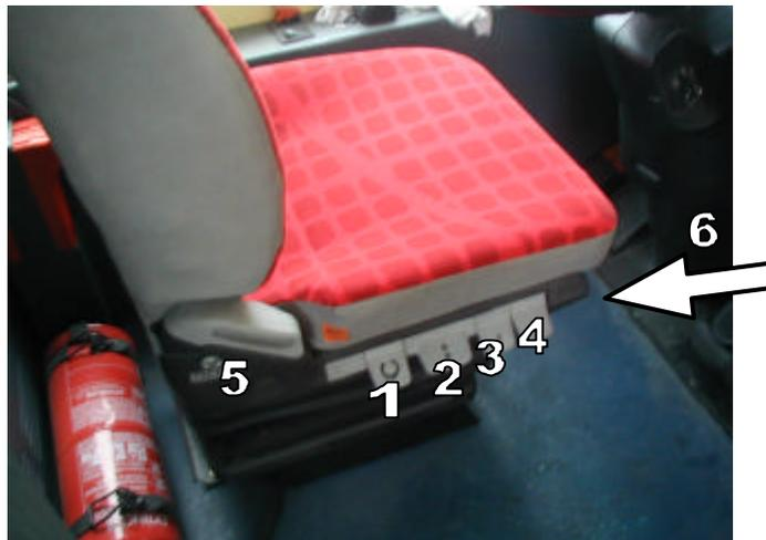
Ajustes: 1. Giro del asiento – 2. Ajuste de altura – 3. Ajuste de amortiguación – 4. Ajuste de inclinación de banqueta – 5. Ajuste de inclinación de respaldo – 6. Palanca de ajuste longitudinal.
