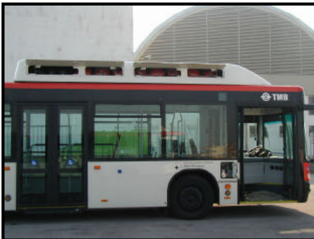
Foto C. Ubicación depósitos gas. MAN
