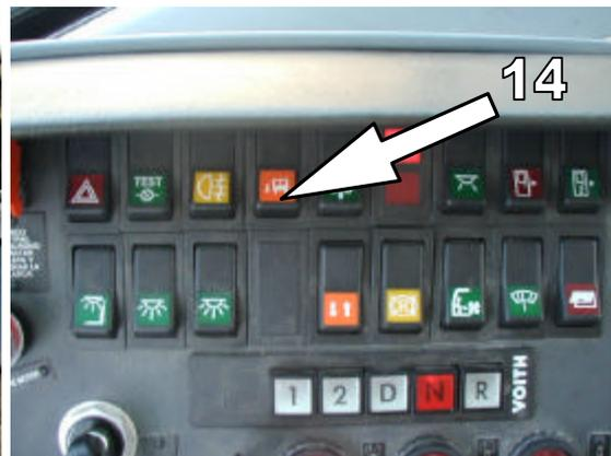
El **arrodillamiento** lateral del autobús se efectúa con el botón 14 (ver dibujo cuadro de instrumentos).
