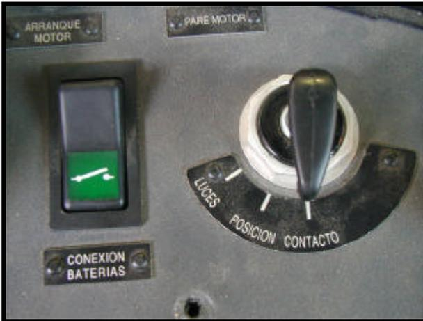
*Foto B. Llave de contacto, desconexión baterías. IVECO*
