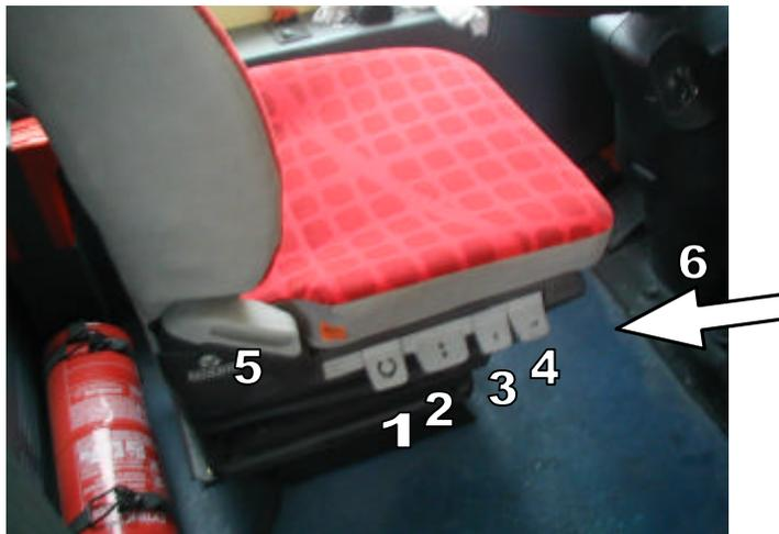
Ajustes: 1. Giro del asiento – 2. Ajuste de altura – 3. Ajuste de amortiguación – 4. Ajuste de inclinación de banqueta – 5. Ajuste de inclinación de respaldo – 6. Palanca de ajuste longitudinal.
