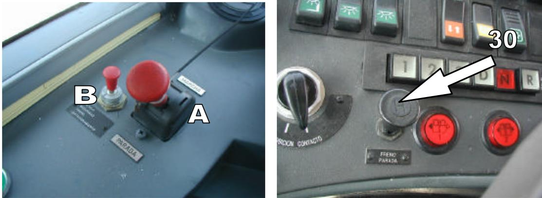
El **freno de parada** sirve para retener el vehículo en un semáforo, por ejemplo, sin necesidad de mantener apretado el pedal de freno.
