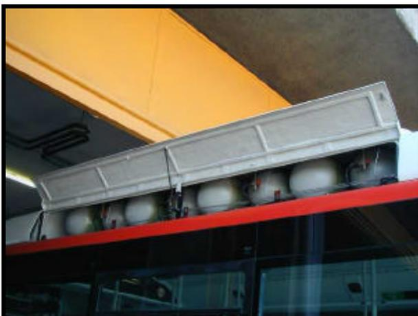
*Foto E. Ubicación depósitos gas. IVECO*
