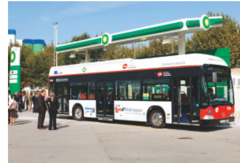
Un dels tres Mercedes propulsats per pila d'hidrogen inclosos al projecte europeu CUTE.
